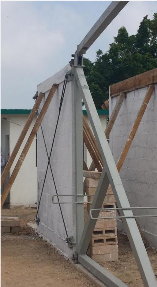
Resultado de la prueba demostraron que las paredes reforzadas con varillas, soportaron mayor carga, convirtiéndose en una opción ideal para el reforzamiento de viviendas antisísmicas.
